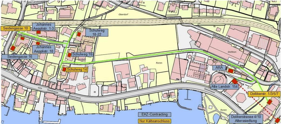
Abbildung 4: Netz und angeschlossene Gebäude des Wärmeverbands ARA Meilen (Quelle: EKZ, April 2023)
