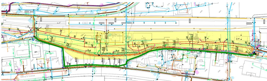
Abbildung 14 – Bauphase mit möglicher Linienführung Werkleitungsprovisorien
