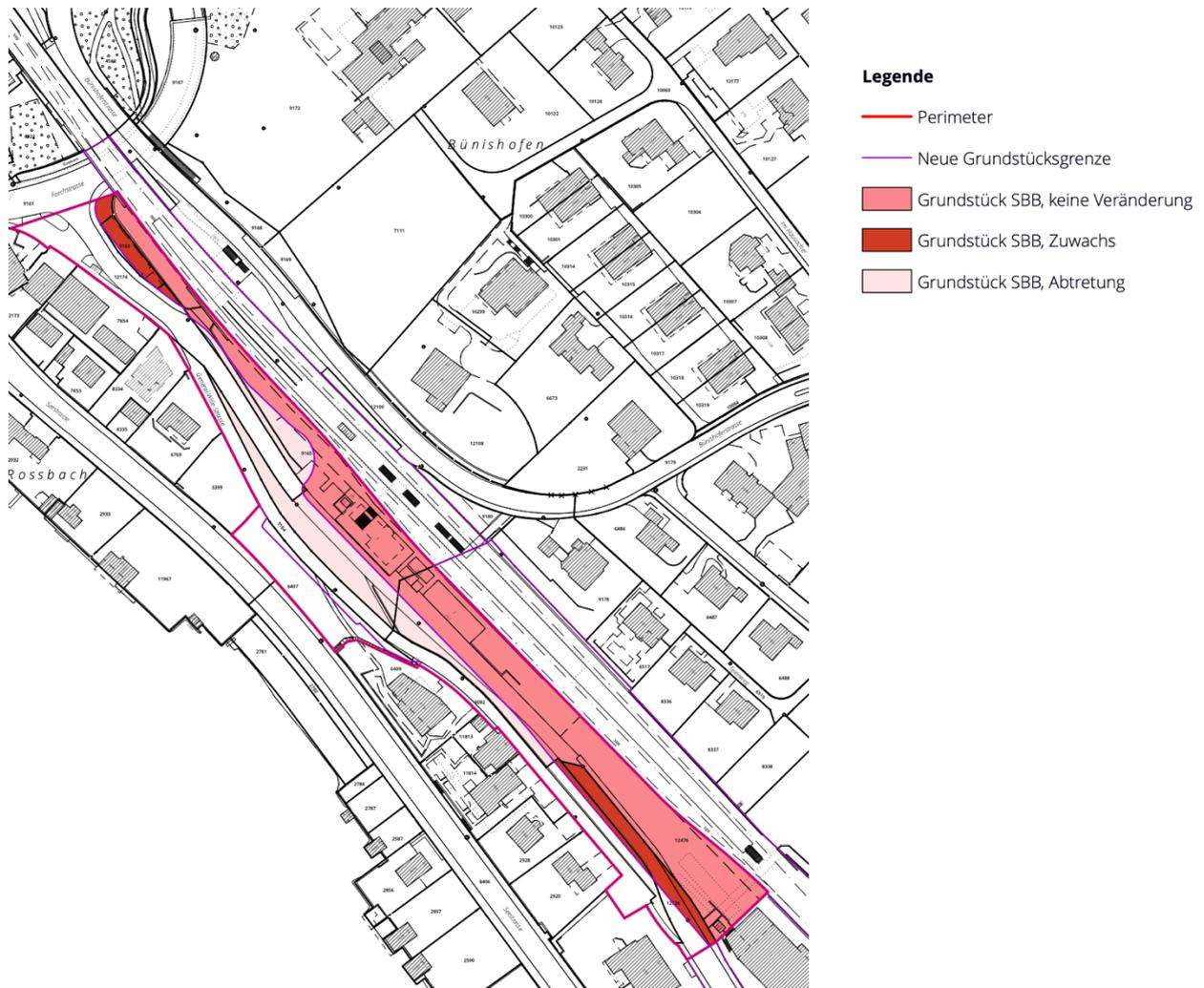
Abbildung 4: Grundeigentum SBB AG mit Zuwachs und Abtretung, massstabslos
