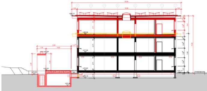
Querschnitt durch Lüftungszentrale mit neuem, zweitem Obergeschoss
