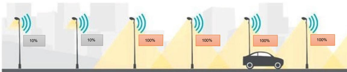
Prinzip Betrieb Grundstufe 100%, Grunddimmung 10%
